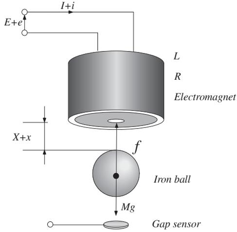
図 1: 磁気浮上システム
